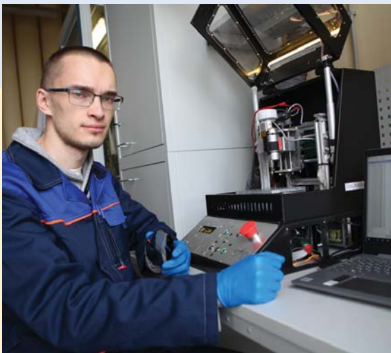
Ярослав Седов, инженер-технолог. Проведение процесса прошивки отверстий в стеклянной пластине микрофлюидного чипа
