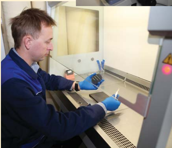
Сергей Карпич, ведущий инженер-технолог. Подготовка к процессу термоанодной сварки кремниевой и стеклянной пластин
